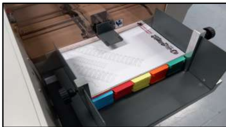
Ajuste del alimentador con topes magnéticos y deslizante
