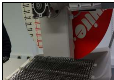
Alimentación desde bobina o longitudes cortadas Wire-O®
