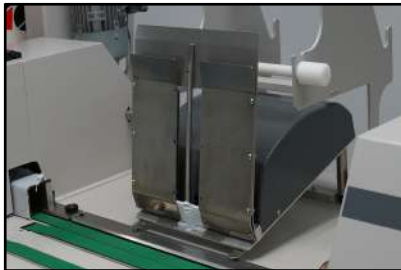
Módulo opcional de alimentación automática de colgadores preformados n°3 y n°7 sueltos (hasta 100 piezas)
