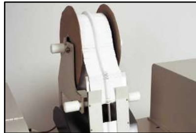
Soporte de rollo con colgadores preformados montado en el módulo de alimentación
