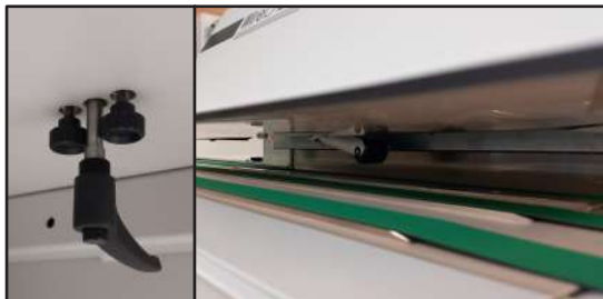
Posibilidad de ajustar el paralelismo de la zona de la cierre Wire-O®
