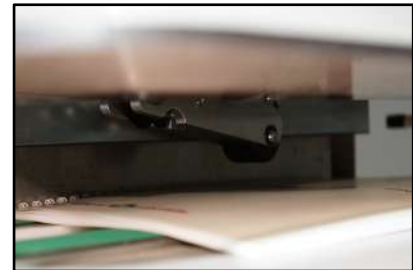
Área de cierre Wire-O® con centrado automático del documento
